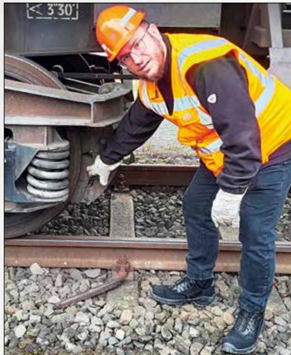
▲▼ Als Wagenmeister muss Sarhan z.B. auf einen ordnungsgemäßen Zustand von Federn und Bremsbelägen achten.
