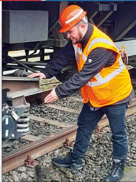
▲▼ Als Wagenmeister muss Sarhan z.B. auf einen ordnungsgemäßen Zustand von Federn und Bremsbelägen achten.
